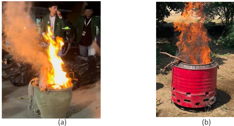
Gambar 5. Perbandingan Pembakaran (a) Metode Konvensional (b) Metode Smokeless Burn Barrel
